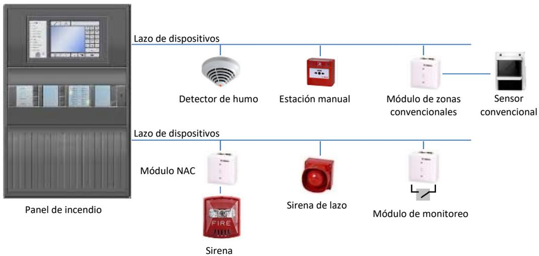
Ilustración 12. Esquema General Sistema de Detección de Incendio
